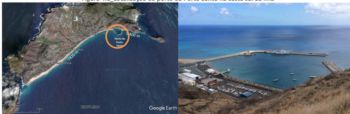
É um porto artificial, com um plano de água com uma forma trapezoidal, protegido por molhes artificiais, sendo os fundos de natureza arenosa. O porto é constituído por uma bacia abrigada com uma área molhada de aproximadamente 233 000 m<sup>2</sup> e tem profundidade máxima de -10,0 m (ZH) e mínima de -1,0 m (ZH). A largura da entrada é de cerca de 150 m medida entre as cabeças dos dois molhes ou quebra-mares.
